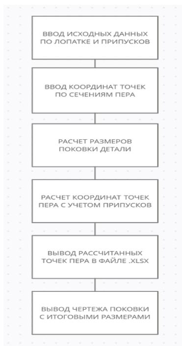
Рисунок 1 – Алгоритм программы для САПР заготовок компрессорных лопаток
