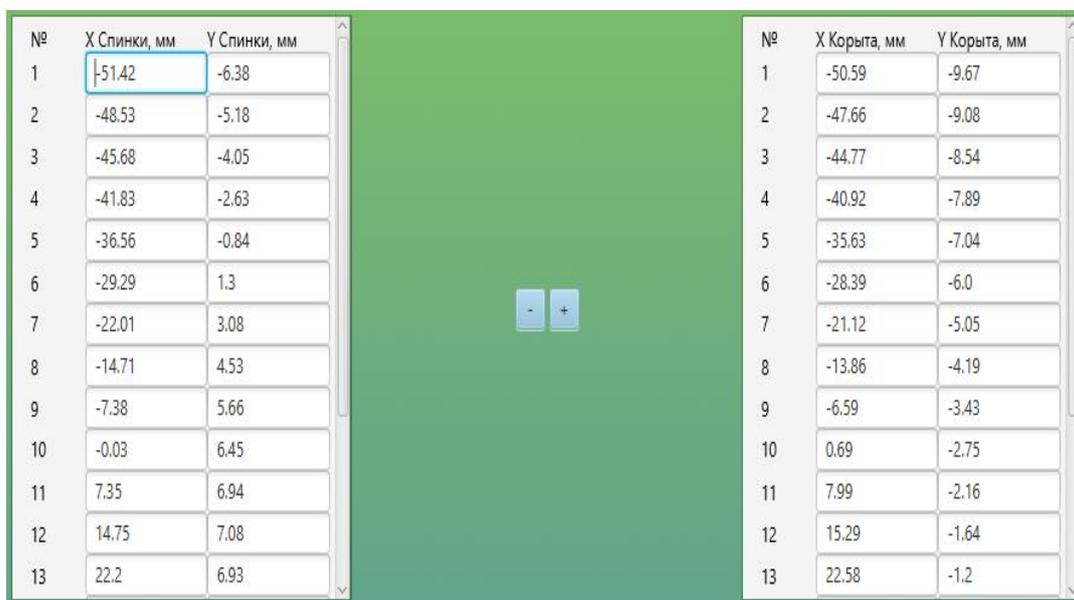
Рисунок 6 – Ввод данных по каждому сечению пера компрессорной лопатки
