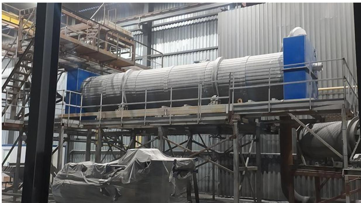
Рисунок 2 – Установка регенерации цеолитов
